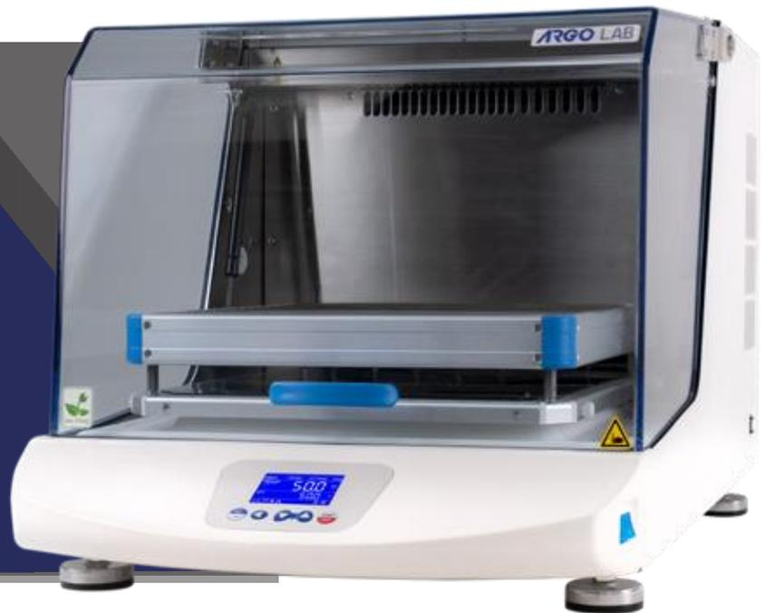
ArgoLab SKI 4 ,SKI 8 e SKI 8R sono strumenti da banco che combinano funzioni di agitazione e termostatazione/refrigerazione in un unico corpo, utilizzati per miscelare liquidi e per incubare colture biologiche.
